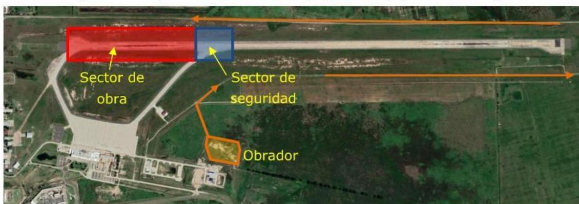
Las operaciones aéreas se limitan a aeronaves hasta letra de clave C, en una pista de 2.000 metros de longitud. El acceso a la pista se realiza por el rodaje Bravo. Dentro de esta etapa de obra se realiza la reconstrucción de pista, la rehabilitación de márgenes de pista, la instalación del nuevo balizamiento y la identificación de franjas.
