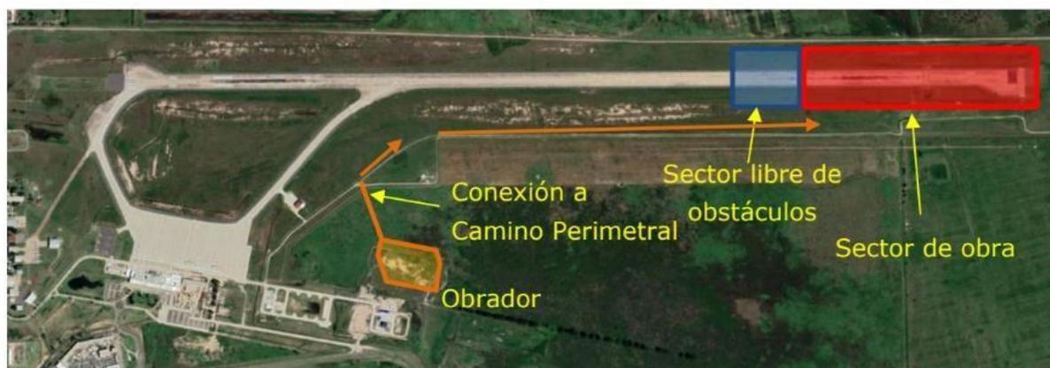
Las operaciones aéreas se limitan a aeronaves hasta letra de clave C, en una pista de 2.000 metros de longitud. El acceso a la pista se realiza por los rodajes Alfa y Bravo. Los despegues por cabecera 20 desplazada se realizarán mediante un viraje de 180° sobre la pista, al igual que el viraje de los aterrizajes que se realicen por cabecera 02.
