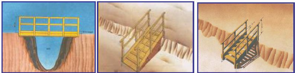
Figura 1. Pasarela, rampas y escaleras.
