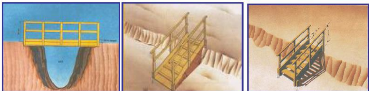
Figura 1. Pasarela, rampas y escaleras.
