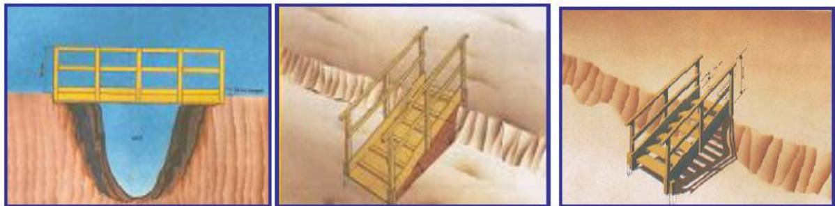
Figura 1. Pasarela, rampas y escaleras.
