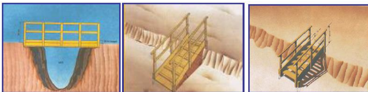
Figura 1. Pasarela, rampas y escaleras.
