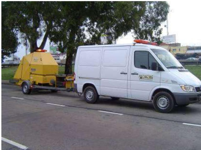
*Figura 6 - Equipo de mediciones deflectométricas KUAB 2m 150*
