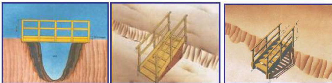
Figura 1. Pasarela, rampas y escaleras.
